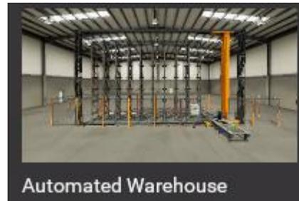
Esta escena consta de una cinta de entrada, en la cual se generan las cajas, una cinta de salida, donde se eliminan las cajas, un “Armario” con 54 huecos para dejar las cajas recibidas, un transelevador para transportar las cajas a los huecos del armario, y he añadido un segundo transelevador, para recoger o sacar las cajas del hueco que queramos por el otro lado, para así poder introducir y retirar cajas simultáneamente.
